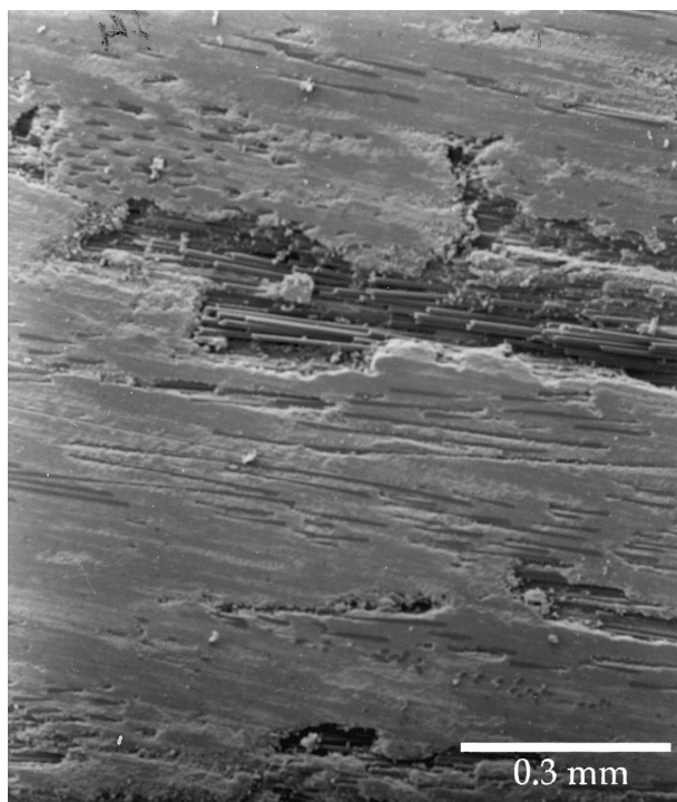
Fig. 18. Composite T400H/YMAS— V=0.1 \text{ m s}^{-1} ; N=50 \text{ daN} ; T=20^\circ\text{C} .
